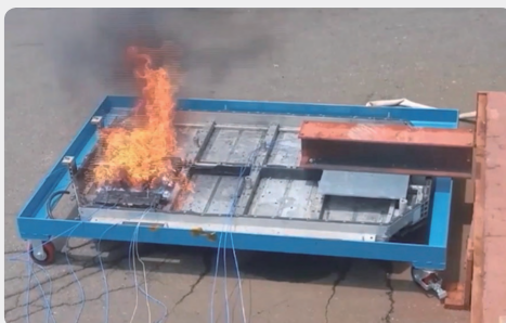
Actual fire test of battery & EV
